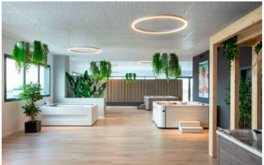
Showroom producto. Luminarias Circular con iluminación difusa en CRI >90 más proyector Atom Hide para enfatizar todos los detalles del producto. Product showroom. Circular light fittings with diffused lighting with CRI >90 and Atom Hide spotlight to highlight all of the product's details.
